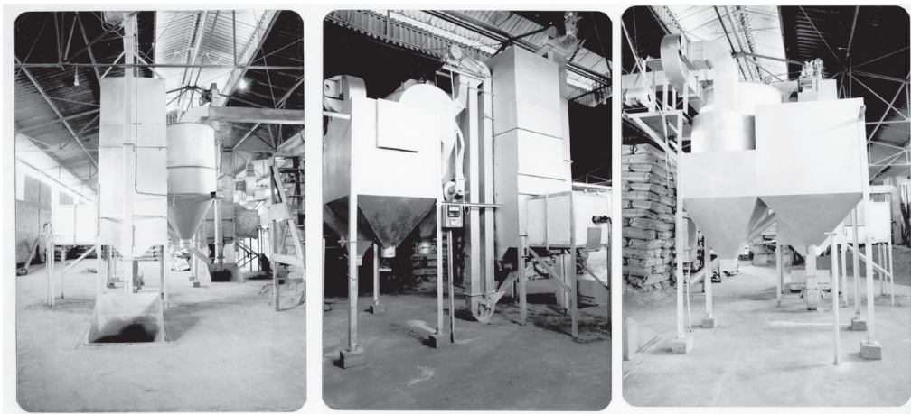
Em diferentes ângulos, o reator para expansão da vermiculita, na Minebra, em Barueri (SP). Foto de 1978
